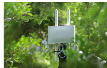
館内の各所に設置された「Cisco Meraki」のアクセスポイント。写真は屋外型の「MR74」。
