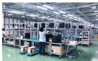
帯電防止素材に覆われた机・床
