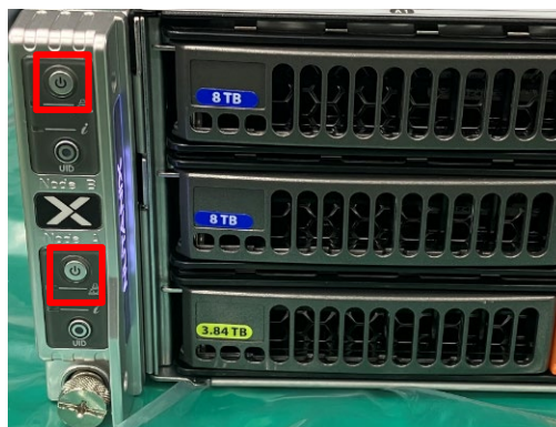
例：NX-1065-G9 の電源ボタン (ノード毎に電源ボタンが存在します)
