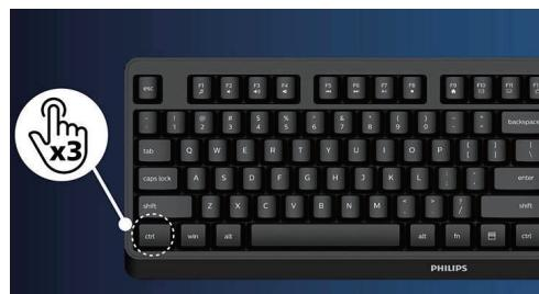
従来のモニターに搭載されているKVMスイッチボタンとは異なり、SmartKVMではキーボード操作だけで入力ソースの切り替えが可能です。すべてのデバイスが正しく接続されていれば、Ctrlキーを3回押すだけで、簡単にソースを切り替えることができます。
