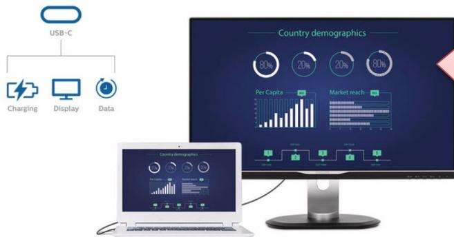
マウスやキーボード、外付けHDD等のUSB機器を接続しておくことで、映像・音声・USB信号の合計3種類の信号と、最大65Wのパワーデリバリー機能を1本にまとめた送受信が可能になります。
