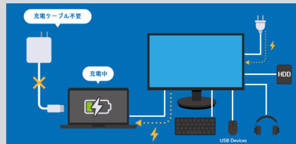
Philipsのウルトラワイドは、ノートPCの充電を行えるだけでなく、ドッキングステーションとしても機能。マウスやヘッドセットをディスプレイに集約して利用することが可能です。
