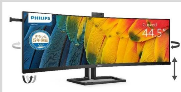
ベース接地面からモニタ画面下辺までの高さを、最大で約23cm上げることができます。このほか、チルトスィーベルにも対応。カメラ&マイクの機能を備えたモデルの展開もございます。
